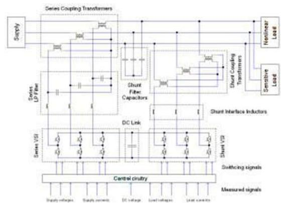
**Fig. 2.UPQC Block Diagram**
